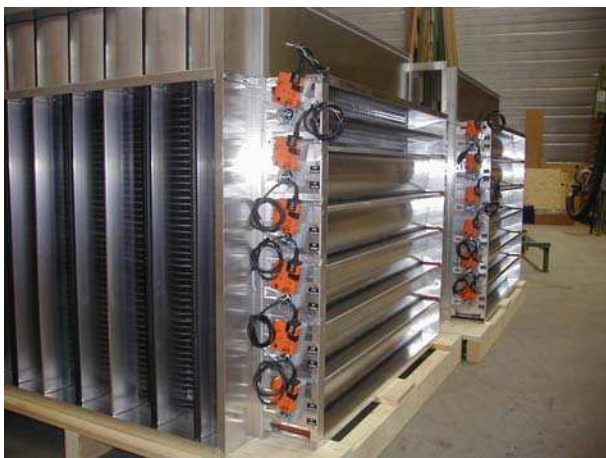
Bild 1 Plattentauscher mit Bypass-Klappen und Defrosterklappensystemen
