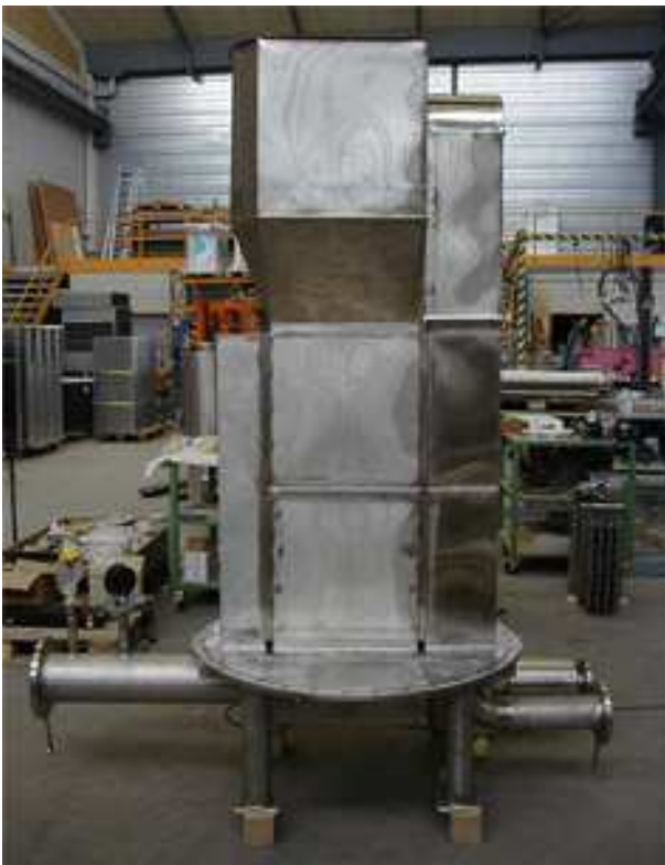
Bild 4 2 Stück GD's in Katalysator eingeschweisst
