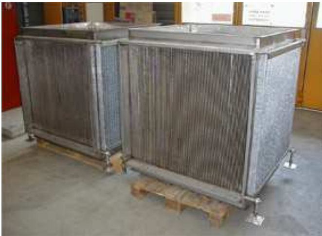
Bild 1 2GD's mit 960 mm Kantenlänge, Breite ca. 1000 mm, Objekt: Paris Absauganlage für Diesellokomotiven
