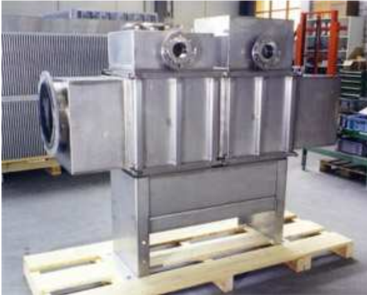
Bild 9 2 GD's hintereinander zusammgebaut Zum Einbau in kundenspezifisches Gehäuse
