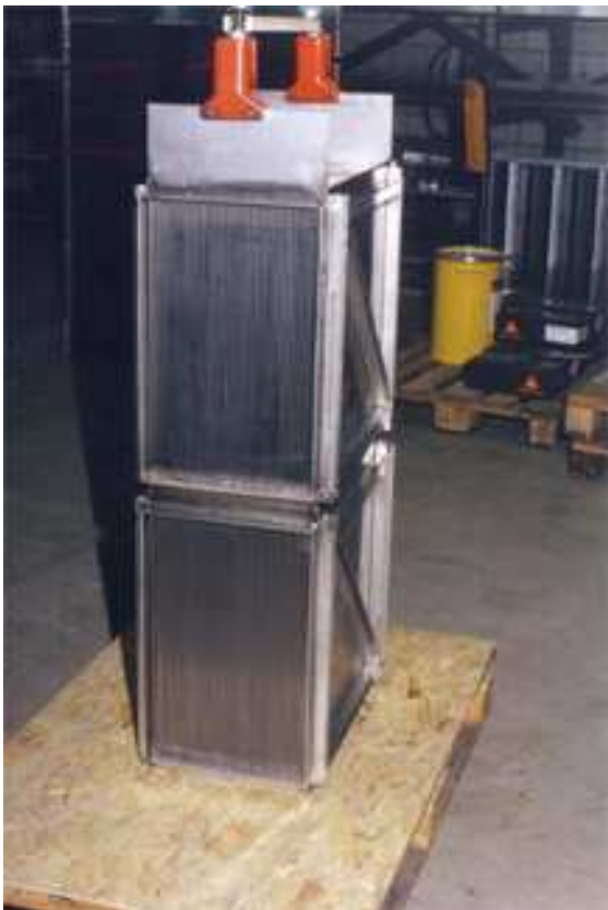
Bild 9 2 GD's hintereinander zusammgebaut Zum Einbau in kundenspezifisches Gehäuse
