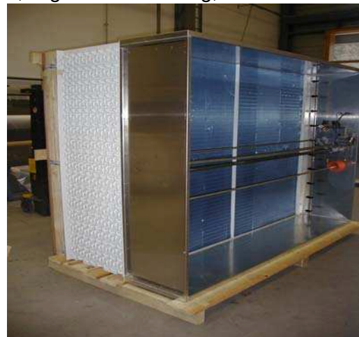
Bild 3/4: Glycol-Register, mit softcool-System, hydrophil beschichtete Lamellen, 16 Rohrreihen, liegende Anordnung, 30'000 m 3 /h
